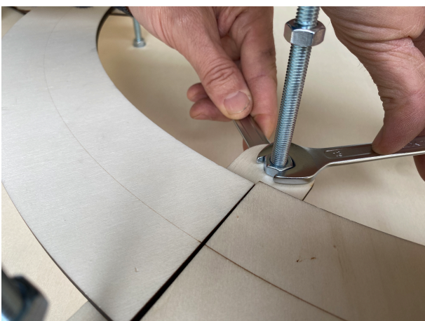
Foto 5. Fissaggio dei dadi alle barre in corrispondenza dei supporti.
